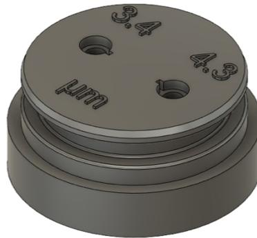
Figure 3-6 : Modèle 3D de l'insert LEDs
